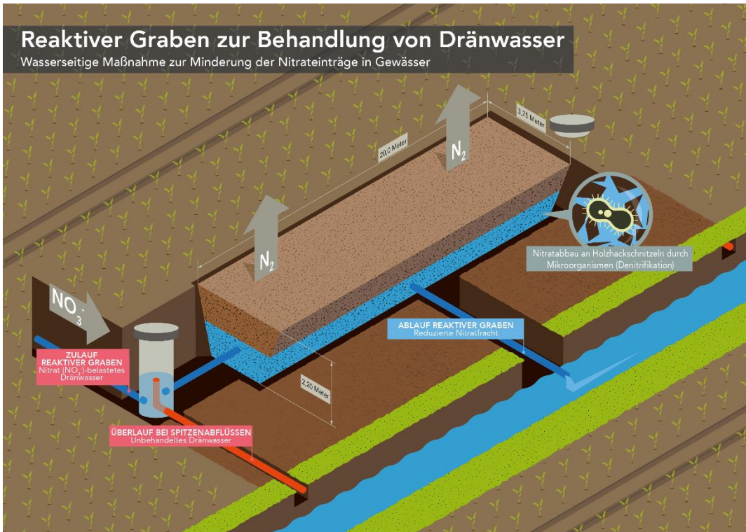
Abbildung 3: Prinzip des reaktiven Draingrabens: das mit Nitrat belastete Drainwasser wird, bevor es in das Gewässer mündet, in den reaktiven Draingraben umgeleitet. Dort bauen Mikroorganismen das Nitrat ab, wofür sie allerdings eine Kohlenstoffquelle (in diesem Fall Holzhackschnitzel) benötigen.
