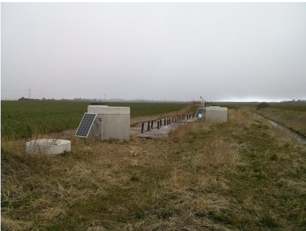
Abbildung 4: Reaktiver Draingraben am Saaler Bach mit Messeinrichtungen der Universität Rostock.
