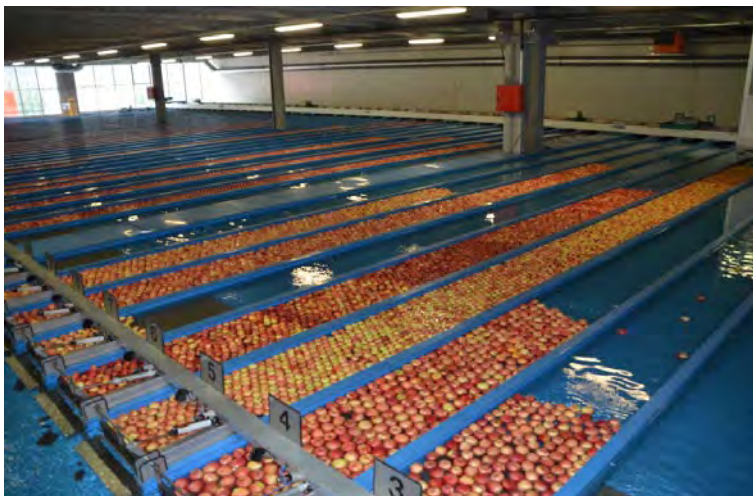
Abb. 2: Schwemmentleerung der Obstbaugenossenschaft Cofrum in Marling.
