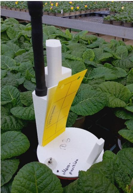
*Abb. 2: Der mit Sensortechnik bestückte Checkpot liefert Satzbezogen Klimadaten und soll Schaderreger-Befall erkennen.*
