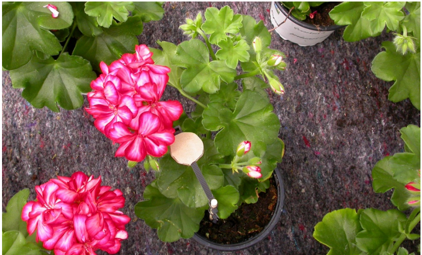
Abb. 3: Der Einsatz künstlicher Blätter erlaubte das Messen von Wirkstoff-Anlagerungsmengen an der Blattunterseite getrennt von der Blattoberseite.
