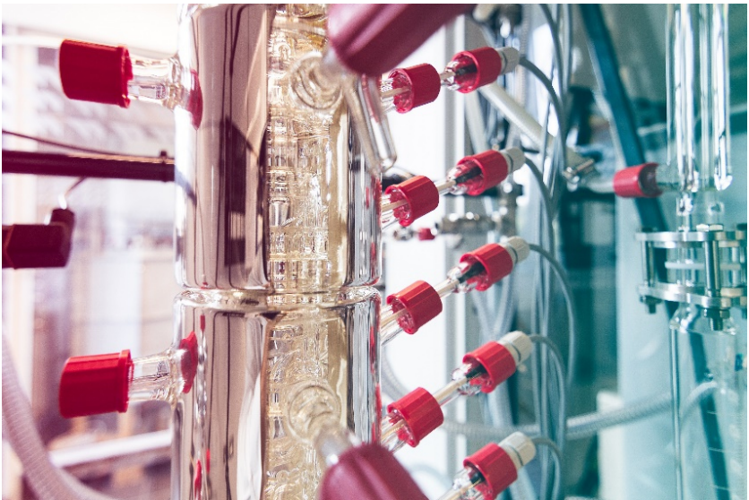
Abb. 1: Im letzten Schritt wird die wasserhaltige Lösung aus dem Apfeltrester destilliert, so dass reines Ethanol entsteht.
