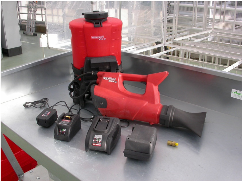
Abb. 1: Im Versuch trat neue luftunterstützte Applikationstechnik (oben) gegen die konventionell geführte Einzeldüse (nächste Seite) an. (alle Fotos: LALLF)
