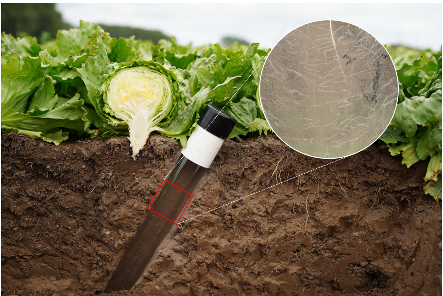
Abb.: Bodenprofil mit Rhizotronröhre im Eissalatbestand nach Versuchsende am 03. Juli 2025 (Quelle: LFA MV)
