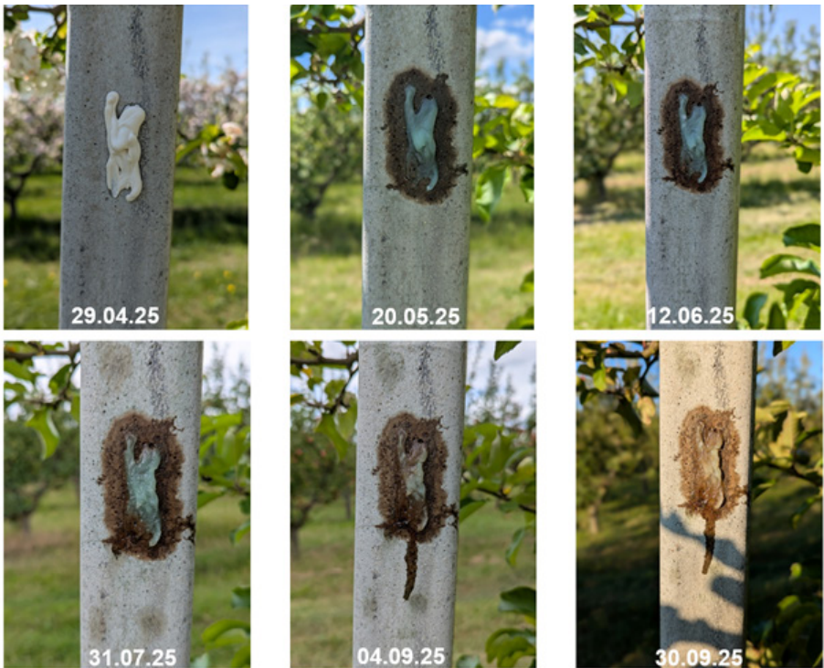
Abb. 12: Veränderung der Konsistenz des Gels auf dem Betonpfahl vom Tag des Auftrags bis Ende September 2025.
