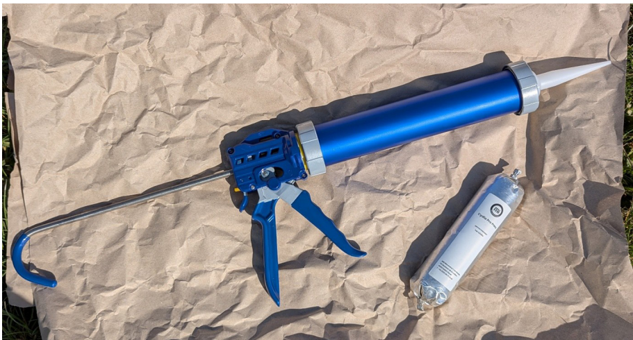
Abb. 4: Das in Schlauchbeuteln verpackte Gel wird mit einer speziellen Kartuschenpresse auf Pfähle oder Unterstützungsrüsts aus Holz, Metall oder Beton aufgetragen.
