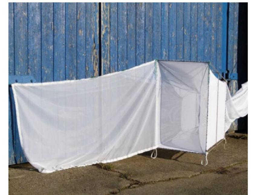
Bild 2: Ansicht der Kastenreuse, die in der Warnow (Standort: Rostock) zur Erfassung des Glas- und Steigaalaufkommens eingesetzt wird
