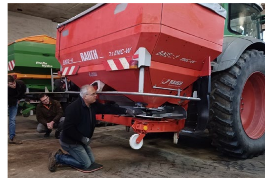
Kontrolle von Verschleiß und die Ausrichtung der Streuschaufeln.
