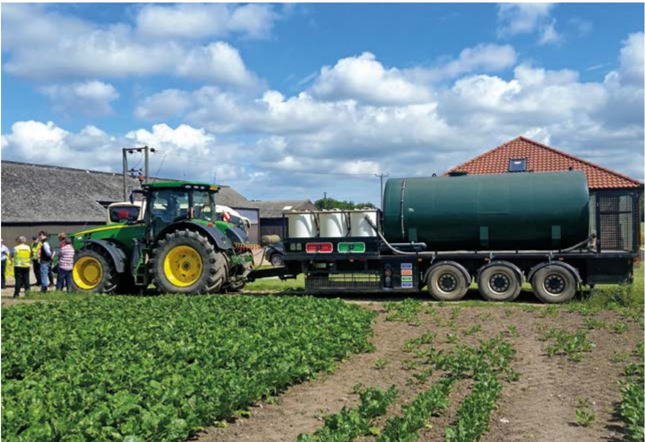
Ein Zubringfass mit drei Vormischbehältern verringert die Rüstzeiten der Feldspritze.
