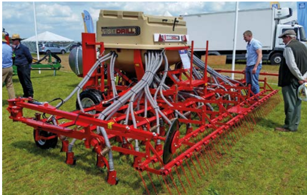
Um bei verspäteter Aussaat in nassen Jahren noch drillen zu können, erfreuen sich einfache Zinkendrilla als Zweitmaschine einer großen Beliebtheit in England.
