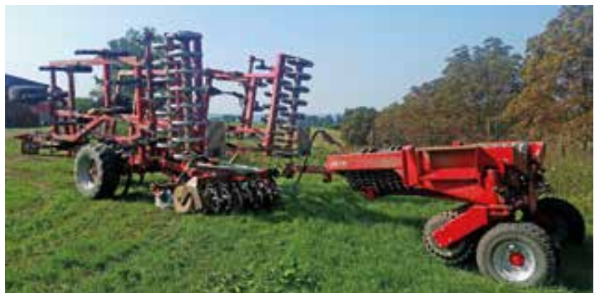
Gerade unter den trockenen Bedingungen des letzten Jahres ist diese Prismenwalze eine sinnvolle Ergänzung zum integrierten Rollflex-Packer (Quelle: eigene Aufnahme)
