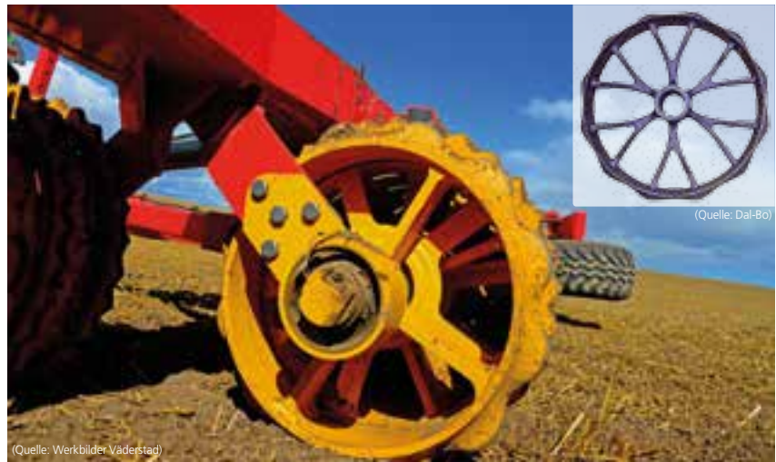
Beim Kauf sollte auch auf Details geachtet werden, wie die SNOWFLAKE-Walzenringe von Dal-Bo (kleines Bild) oder eine gummiiumhüllte Lagerung (großes Bild).
