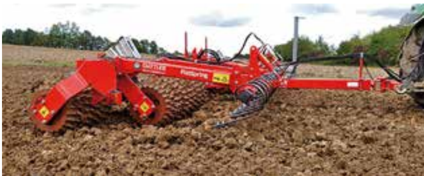
Durch eine zusätzliche Schleppschiene können Ackerwalzen auch zur Saatbettbereitung genutzt werden. (Quelle: Güttler GmbH)
