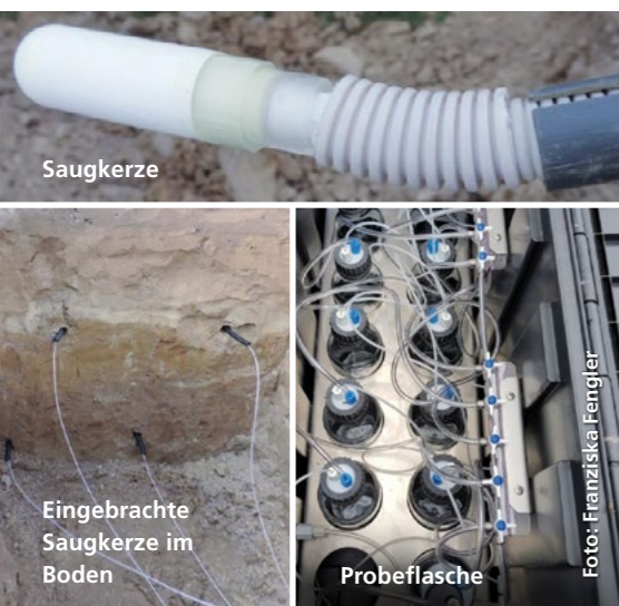
Abbildung 1: Sickerwassergewinnung unter landwirtschaftlicher Fläche mittels Saugkerzen im Boden
