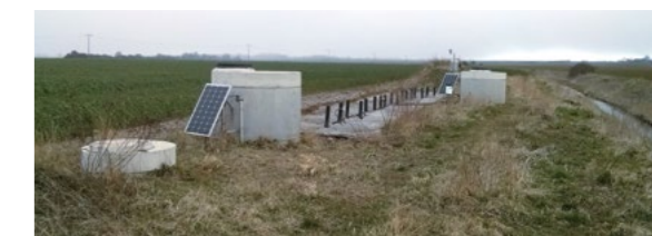
Abbildung 4: Reaktiver Draingraben am Saaler Bach mit Messeinrichtungen der Universität Rostock.
