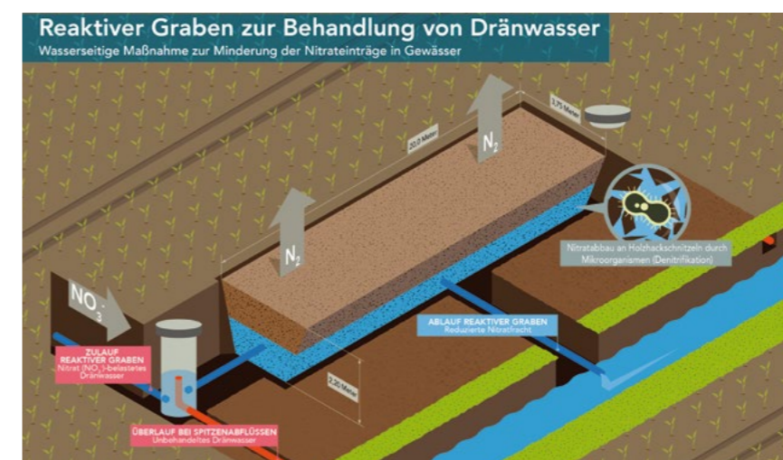
Abbildung 3: Prinzip des reaktiven Draingrabens: das mit Nitrat belastete Drainwasser wird, bevor es in das Gewässer mündet, in den reaktiven Draingraben umgeleitet. Dort bauen Mikroorganismen das Nitrat ab, wofür sie allerdings eine Kohlenstoffquelle (in diesem Fall Holzhackschnitzel) benötigen.
