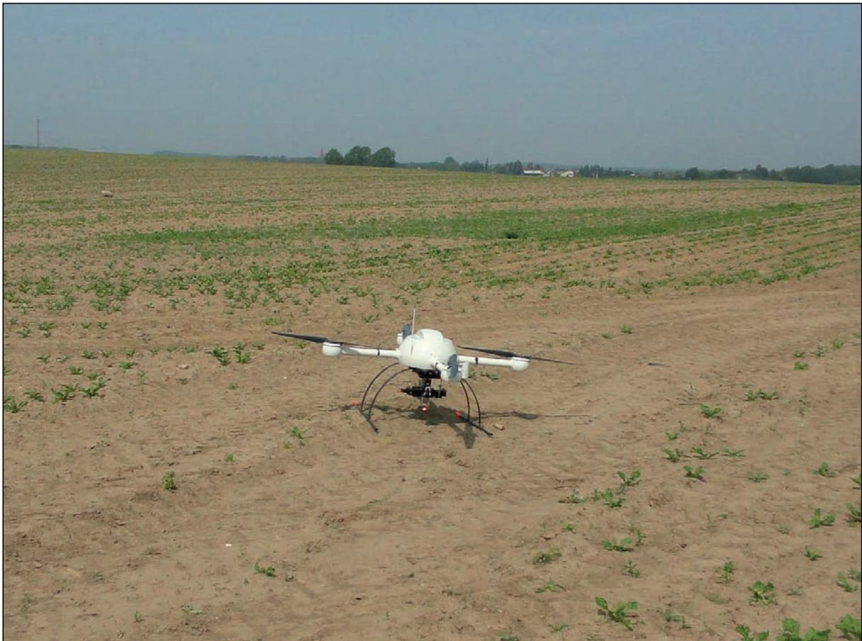
Abbildung 8: Drohne (Quatrokopter), ausgestattet mit Kamerasystem zur Erzeugung von Luftbildern zur Dokumentation der Bodenerosion, © Kastell
